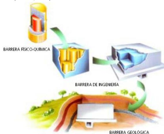
Fig. 10: Almacenamiento de los residuos nucleares de muy baja, baja y media actividad para evitar la radiación.
